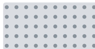
RG 3310 Průměr díry 3,3 mm Podíl otevřené plochy 10%
